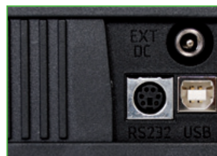
Terminal de conexión para sonda; puertos USB y RS232 de comunicación.
