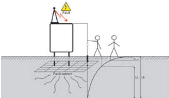
Tensiones peligrosas en un sistema de puesta a tierra defectuoso
